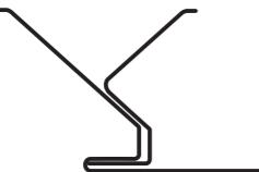
Система крепления разработана и запатентована Grand Line. Панели сайдинга можно монтировать снизу вверх. Замок обеспечивает надежное сцепление панелей и защищает фасад от попадания влаги внутрь конструкции.
