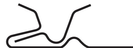
Усовершенствованная конструкция замка сайдинга **Блок-хаус GL** с дополнительным элементом жесткости обеспечивает сцепку изделий таким образом, что панели не перемещаются относительно друг друга.
